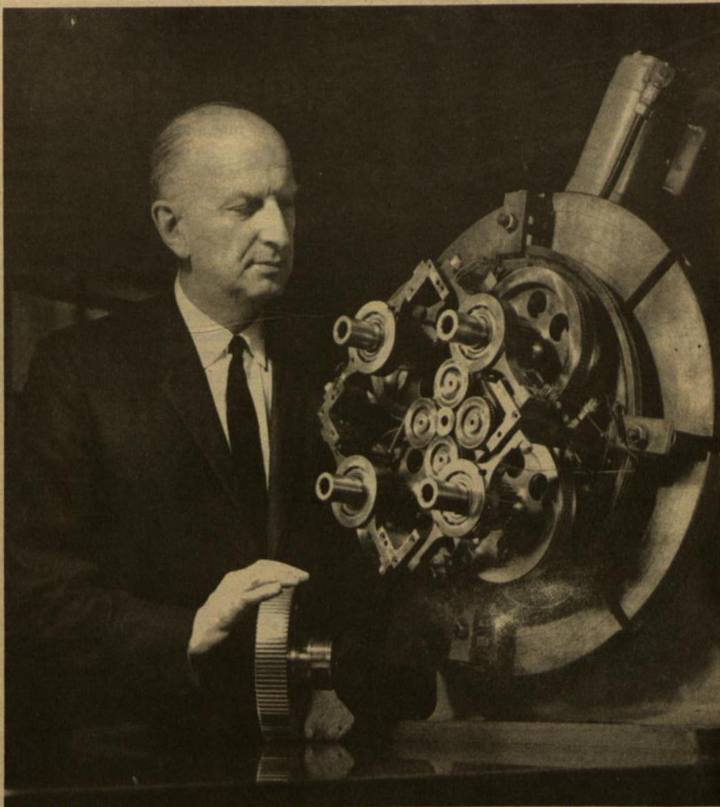
Inž. dr. Algirdas L. Nasvytis prie savo išradimo - helikopterio transmisijos.
