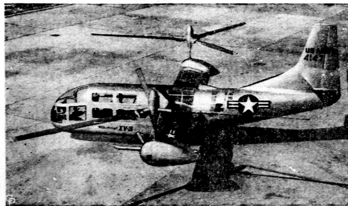
Šioks naujausias armijos lėktuvas gali skristi kaip helikopteris ir kaip paprastas lėktuvas. Lėktuvas pakyla iš vietos b ir išsarg jimo ir skrenda gana greitai.
