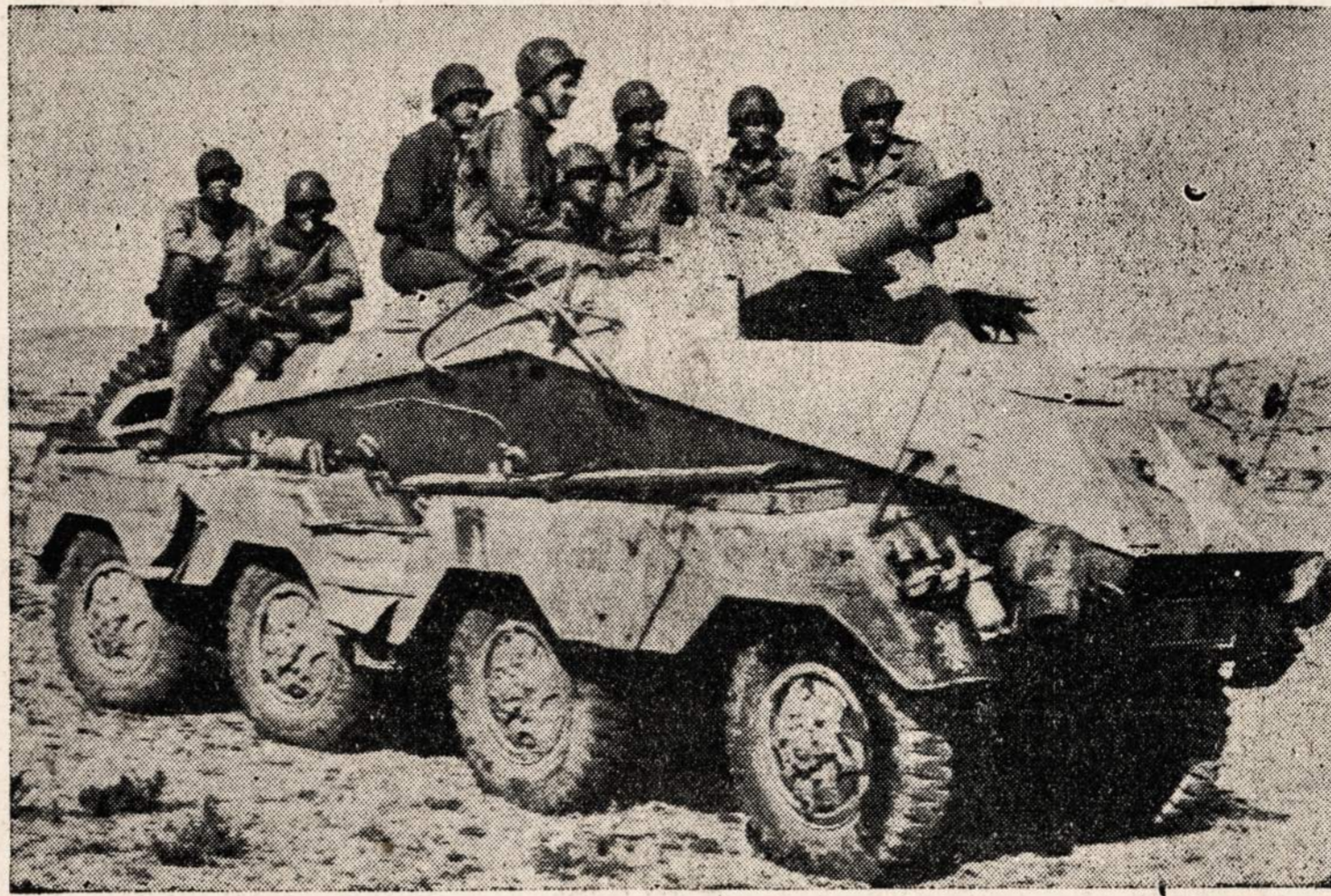
Vokiečių tankų naikintuvai, kurie gali važiuoti ir pirmyn ir atgal, kadangi kontroliavimo aparatai yra abiejose galuose. Naikintuvai liko sąjungininkų užgrobtas Tunisijoje ir dabar yra naudojamas prieš nacius.
